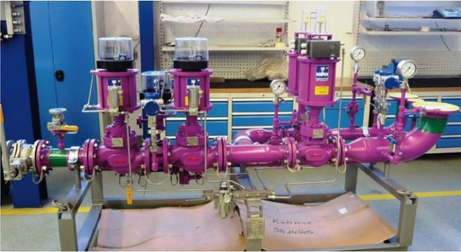
Abb. 4: Gas-Brenner-Armaturenstation mit Schnellschlussventil-Kombination und Mengenregelventil
