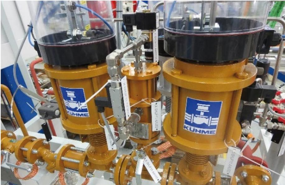
Abb. 12: Automatische Dichtheitskontrolle für flüssige Brennstoffe an einer Schnellschlussventil-Kombination,
