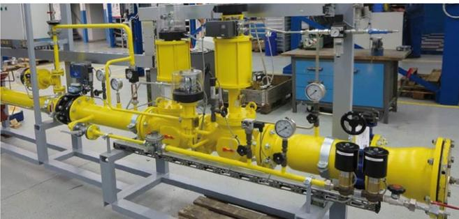
Abb. 6: Gas-Brenner-Armaturenstation mit Hybrid-Armatur
