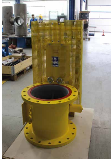
Abb. 11: Koksgas-Sicherheitsabsperreinrichtung Vorher – Nachher (Quelle: KÜHME Armaturen GmbH)
