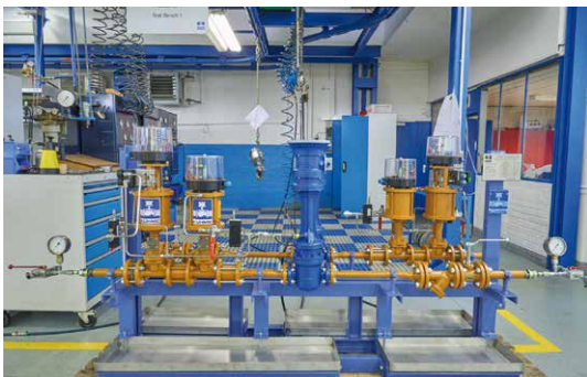
Abb. 7: Öl-Brenner-Armaturenstation mit Hy- brid-Armatur (Quelle: KÜHME Armaturen GmbH)
