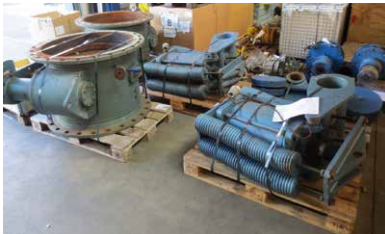
Abb. 12: Gichtgas-Sicherheitsabsperreinrichtung Vorher – Nachher (Quelle: KÜHME Armaturen GmbH)
