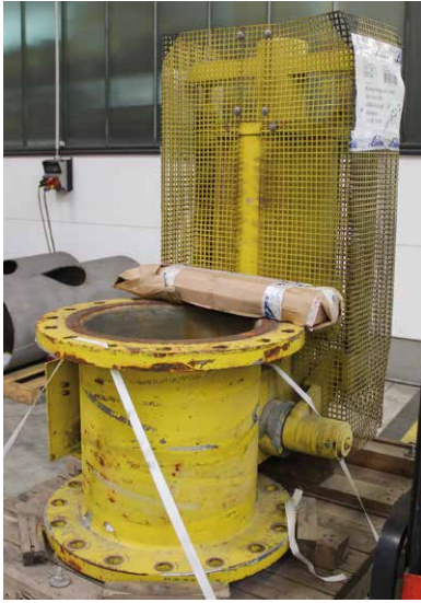
Abb. 11: Koksgas-Sicherheitsabsperreinrichtung Vorher – Nachher (Quelle: KÜHME Armaturen GmbH)
