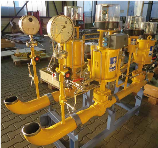
Abb. 8: Gas-Brenner-Armaturenstation mit Hybrid-Armatur (Quelle: KÜHME Armaturen GmbH)
