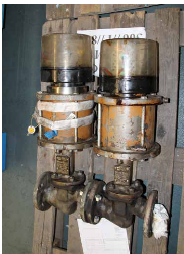
Abb. 10: Öl-Sicherheitsabsperreinrichtung Vorher – Nachher (Quelle: KÜHME Armaturen GmbH)
